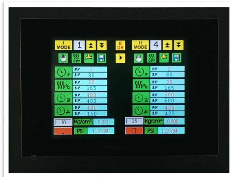
1. Интуитивный пользовательский интерфейс позволяет установить давление, температуру нагрева, время нагрева и охлаждения.
